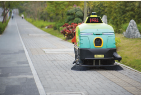
无人清扫机清扫城市道路
